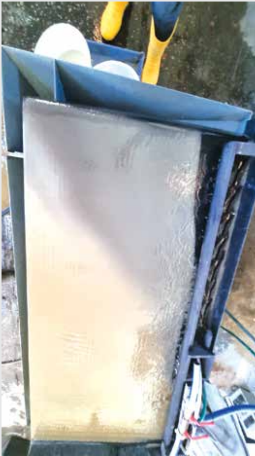
Separácia sulfidov na vibračnom splave / Separation of sulphides on a shaking table
