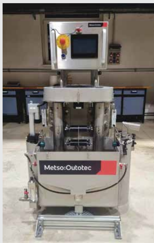
Poloprevádzková flotačná cela / Semi-operational flotation cell
