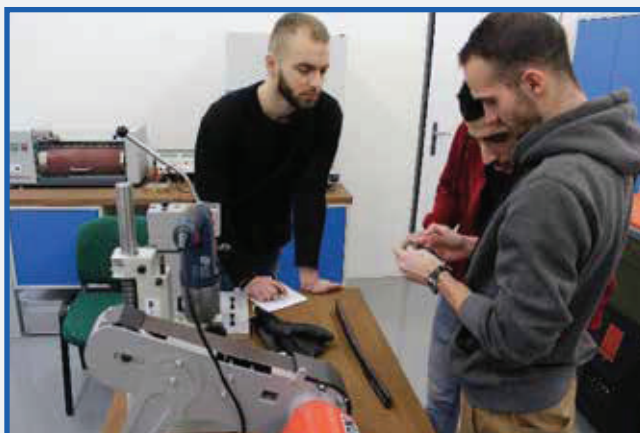
Meranie rozmerov skúšobného telesa dopravného pásu Measuring the dimension of test piece of conveyor belt
