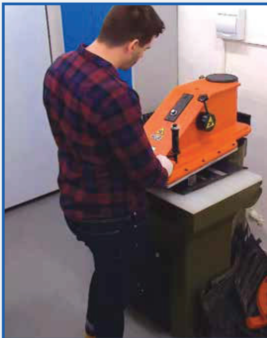
Vyseknutie skúšobného telesa dopravného pásu Cutting the specimen of conveyor belt
