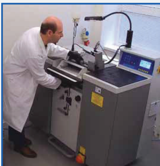
Zrezanie krycej vrstvy dopravného pásu Splitting the cover layer of conveyor belt
