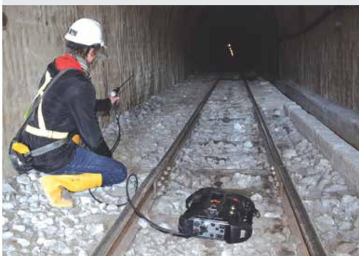
**Analyzačný box pre systém analýzy spalín TESTO 350, umožňuje precízne meranie šiestimi senzormi, z toho je päť senzorov voliteľných (CO, NO, NO<sub>2</sub>, SO<sub>2</sub>, H<sub>2</sub>S, CxHy alebo CO<sub>2</sub>) /**
