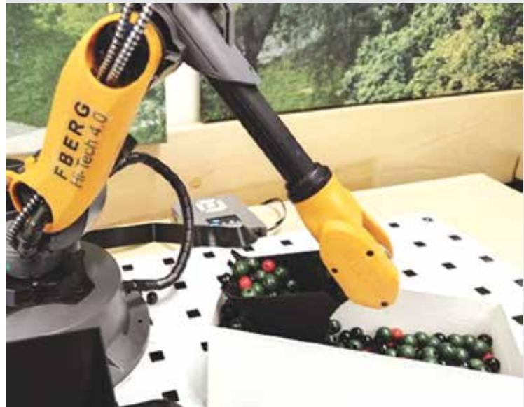
**Vďaka rôznym zariadeniam dokáže edukatívny robotov a jeho prvky verne napodobniť rôzne zariadenia z reálnych prevádzok . V tomto prípade sme z robotického manipulátora vytvorili nakladač. Vďaka tomu dokážeme simulaovať nakladanie a vykladanie rôzneho materiálu /**
