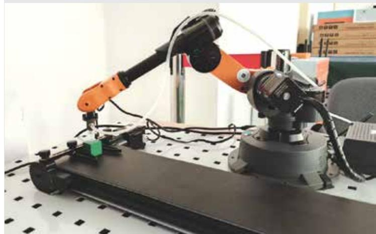
**Pomocou edukatívnych robotov dokážeme vytvárať takmer rovnaké logistické operácie, aké prebiehajú v reálnych prevádzkach rôznych logistických centier. Pomocou rôznych pneumatických zariadení dokážeme modelovať činnosti ako vyzdvihni – polož /**
