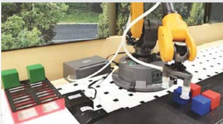
**Využitie nekonečného dopravníkového pásu, dvojitého pneumatického zariadenia a palety nám umožňuje simulovať a modelovať nakladanie a následnú distribúciu tak, ako sa to deje na dennej báze v logistických centrách, obchodoch a veľkých priemyselných firmách /**
