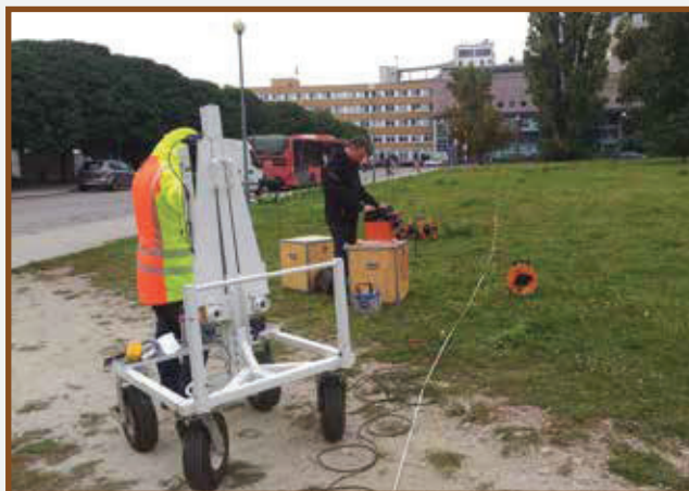
Seizmická aparátúra v teréne. Kladivo ESS-100 a Terraloc Mk 8 Seismic apparatus in the field. ESS-100 hammer and Terraloc Mk 8
