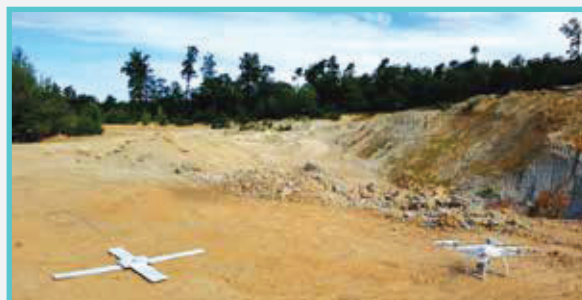
UAV fotogrametrické zameranie povrchového lomu UAV photogrammetric survey of a surface quarry
