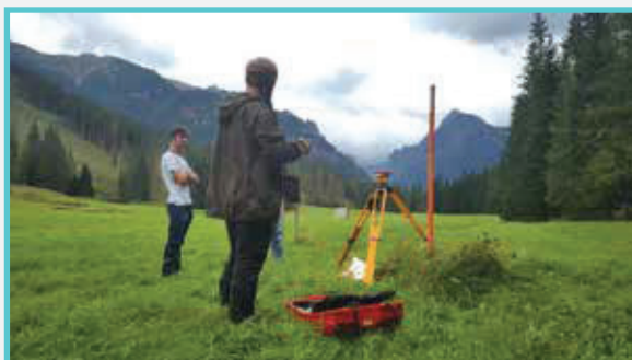
Monitorovanie bodového poľa využitím GNSS Monitoring of a geodetic point field using GNSS
