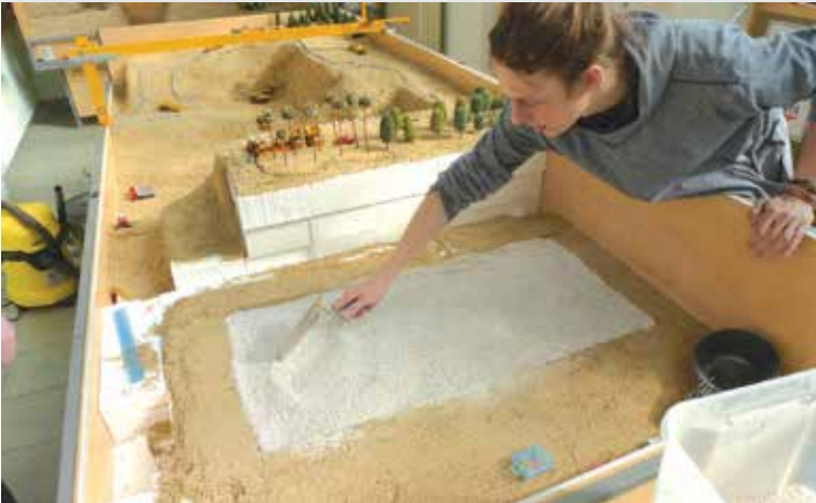
Stanovovanie objemu jednoduchého zárezu jeho vyplnením sypkým materiálom / Determination of the volume of a simple quarry cut by filling it with bulk material
