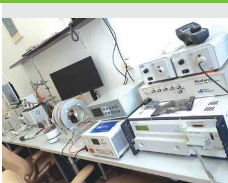
Pohľad na zariadenia pre meranie zeta potenciálu, viskozity a magnetofotonických síl v disperzných systémoch /
