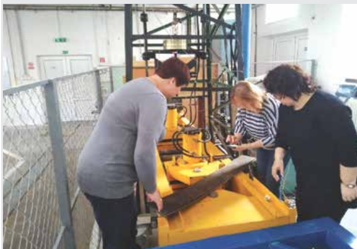
Kontrola poškodenia dopravného pásu / Controlling of conveyor belt damage
