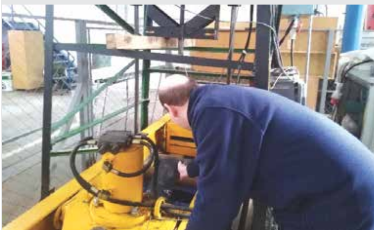
Upnutie vzorky dopravného pásu / Clamping the sample of conveyor belt
