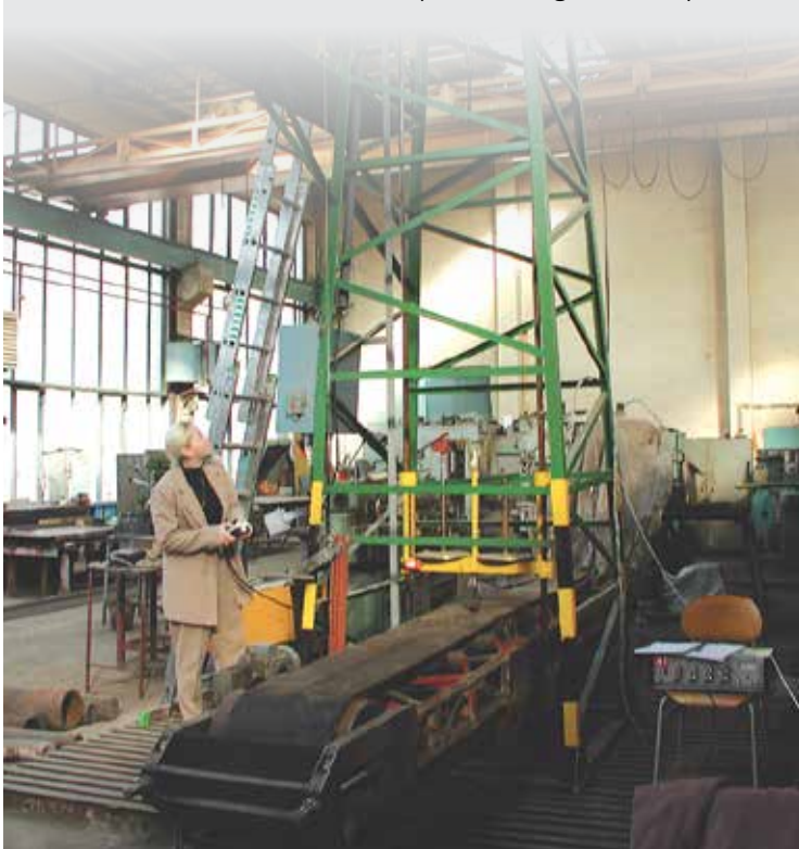
Testovanie dopravného pásu rázom / Impact testing of conveyor belt
