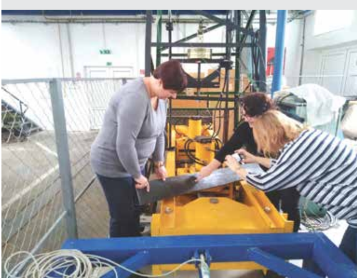
Dokumentácia poškodenia dopravného pásu / Documentation of conveyor belt damage
