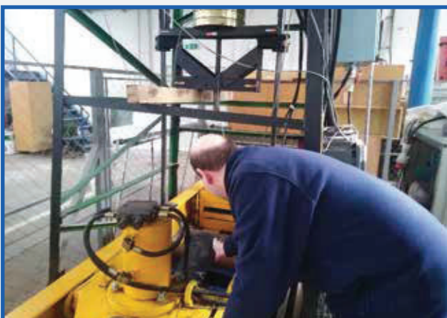
Upnutie vzorky dopravného pásu Clamping the sample of conveyor belt
