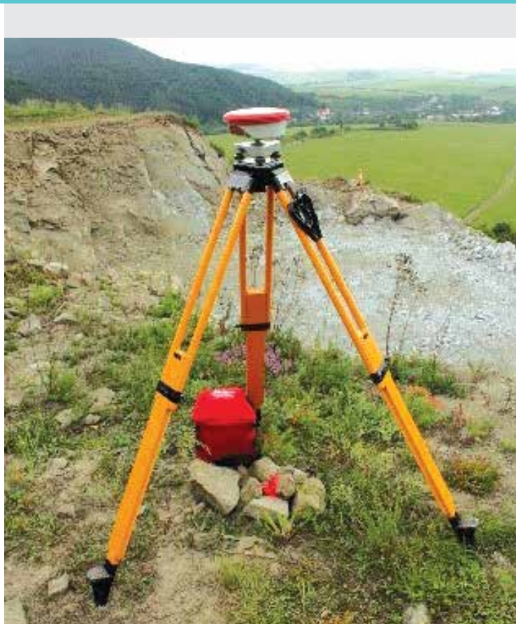
Meranie pomocou globálnych navigačných satelitných systémov zn. Leica – statická metóda / Measurements using GNSS system Leica – static method
