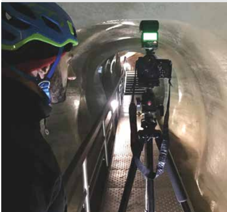
Fotogrametrické zameranie ľadového tunela v Dobšinskej ľadovej jaskyni / Photogrammetric survey of the ice tunnel in the Dobšiná Ice Cave
