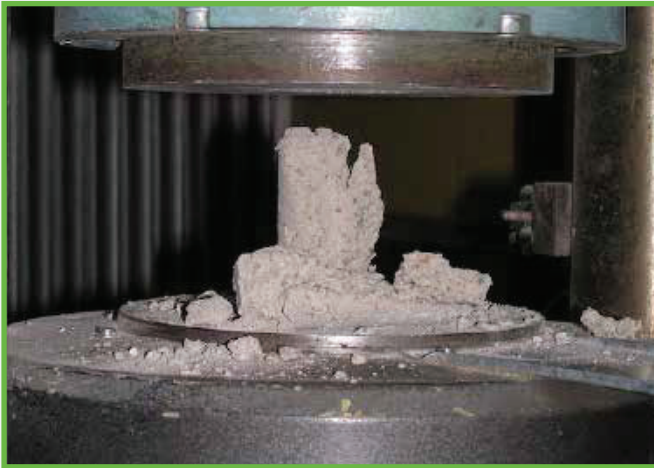
Skúška pevnosti v tlaku na vzorke betónu Compressive strength test on a concrete sample
