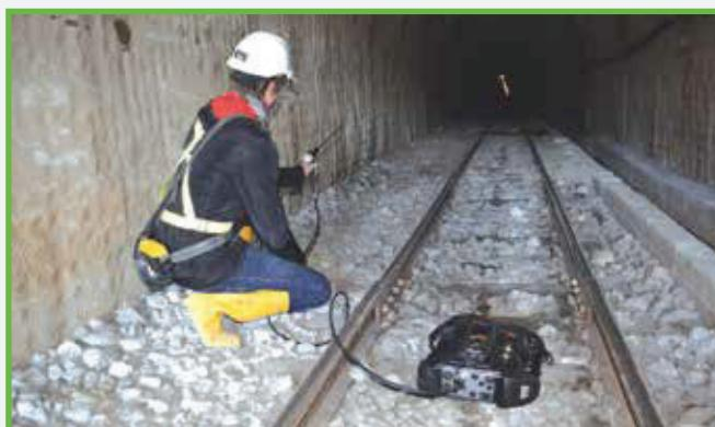
Analyzačný box pre systém analýzy spalín TESTO 350, umožňuje precízne meranie šiestimi senzormi, z toho je päť senzorov voliteľných (CO, NO, NO<sub>2</sub>, SO<sub>2</sub>, H<sub>2</sub>S, CxHy alebo CO<sub>2</sub>).
