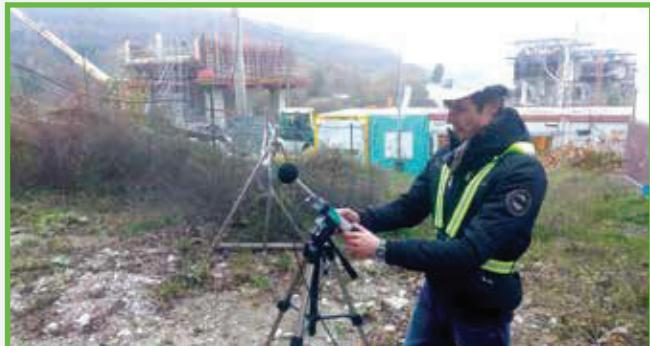
Prenosný prístroj Microdust Pro meria celkovú prašnosť v reálnom čase vo vonkajšom prostredí. Je určený aj pre merania vo vnútornom prostredí. The Microdust Pro portable instrument measures total dust in real-time outdoors. Its design makes him ideal for measurements in the indoor environment.
